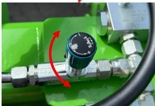
Rysunek 16 Zawór regulujący prędkość opadania listwy
