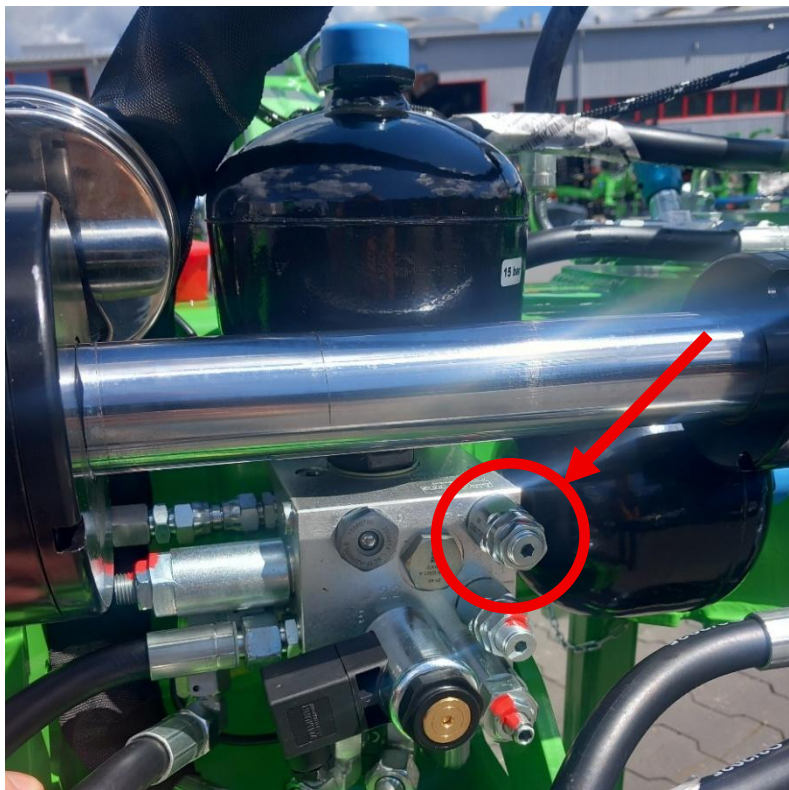
Rysunek 34 Zbicie ciśnienia z układu
