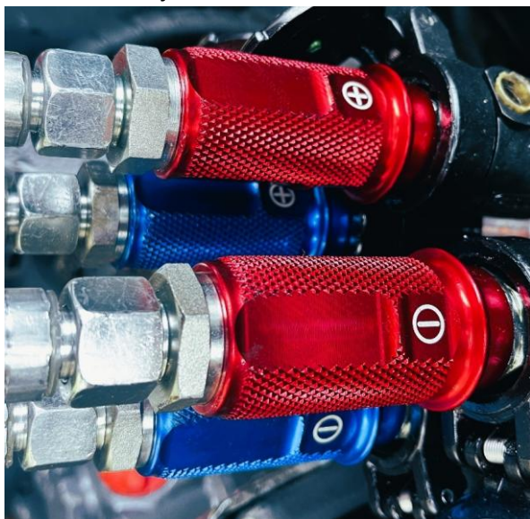
Rysunek 11 Oznaczenie przewodów hydraulicznych
