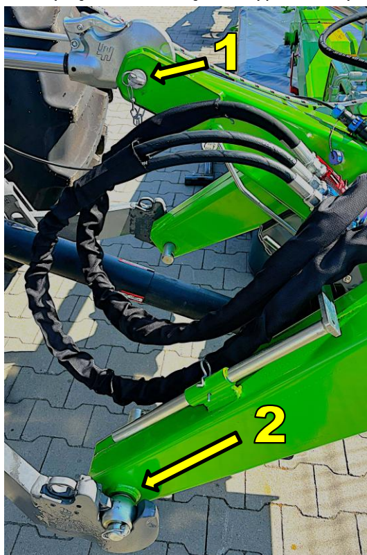
Rysunek 9 Połączenie ramy zaczepowej z ciągnikiem
