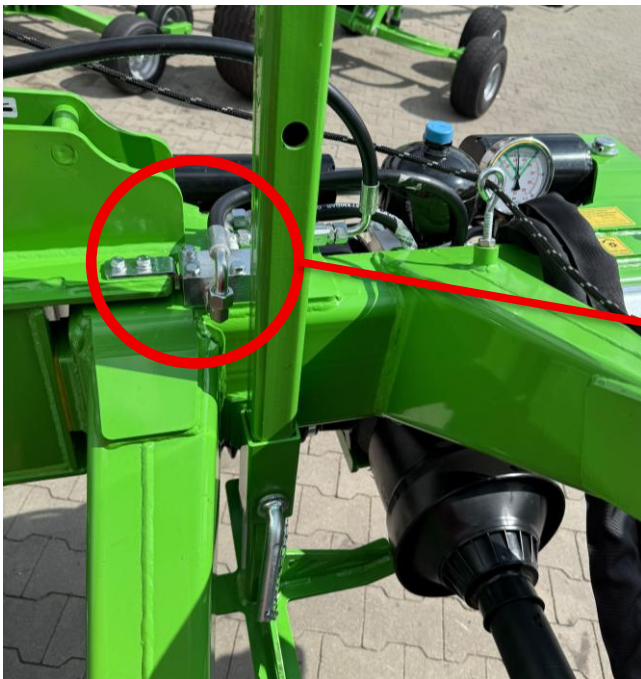
Rysunek 20 Położenie zaworu krańcowego
