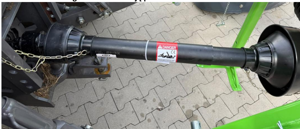
Rysunek 10 Montaż wału przegubowo-teleskopowego
