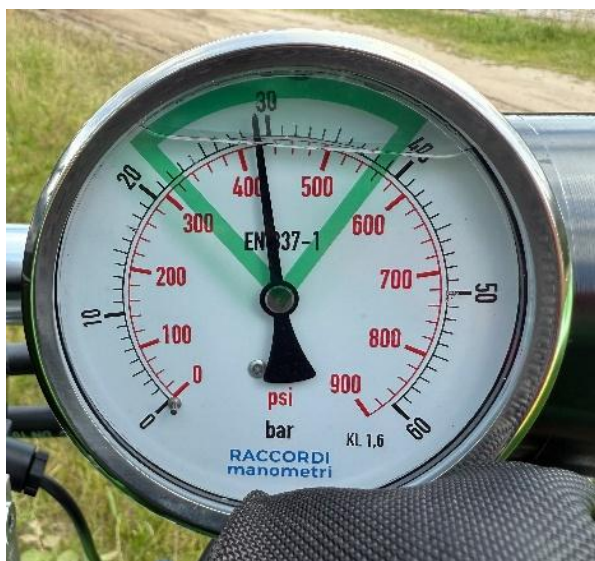
Rysunek 23 Prawidłowe wskazanie manometru
