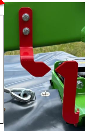
Rysunek 17 Wskaźniki położenia ramienia względem ramy
