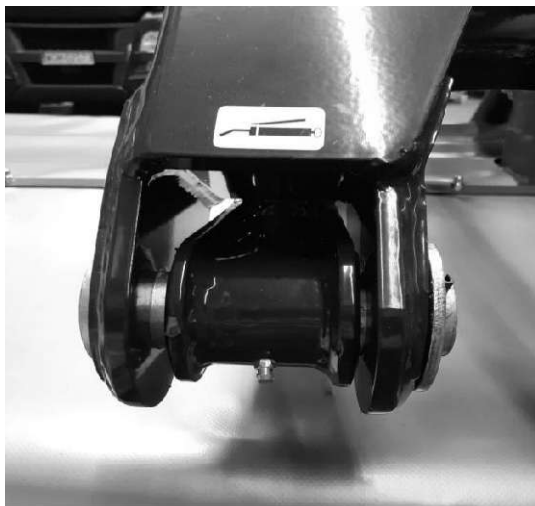
Rys. 17. Oznaczenie punktów smarowania przy użyciu smaru stałego
