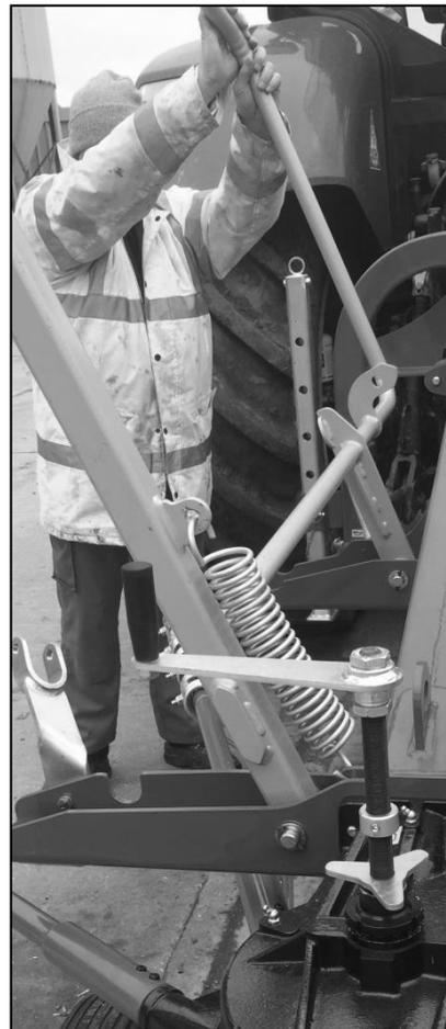
Abb. 6. Auf- und Zuklappen der Schutzbügel
