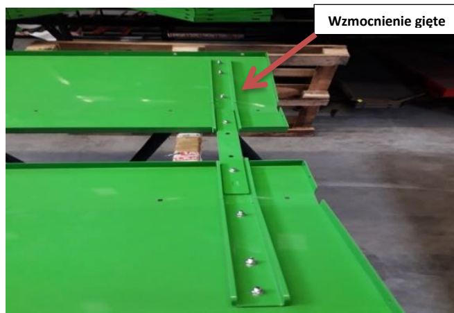
Rysunek 28 Etap II Montaż wzmocnienia giętego
