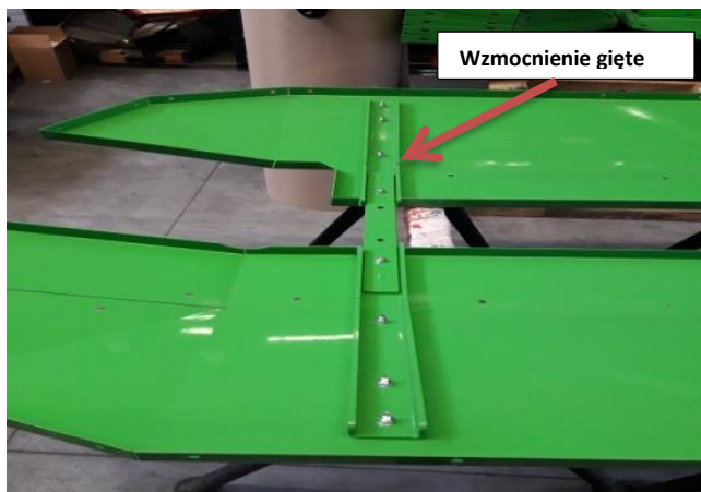
Rysunek 27 Etap II montaż wzmocnienie giętego
