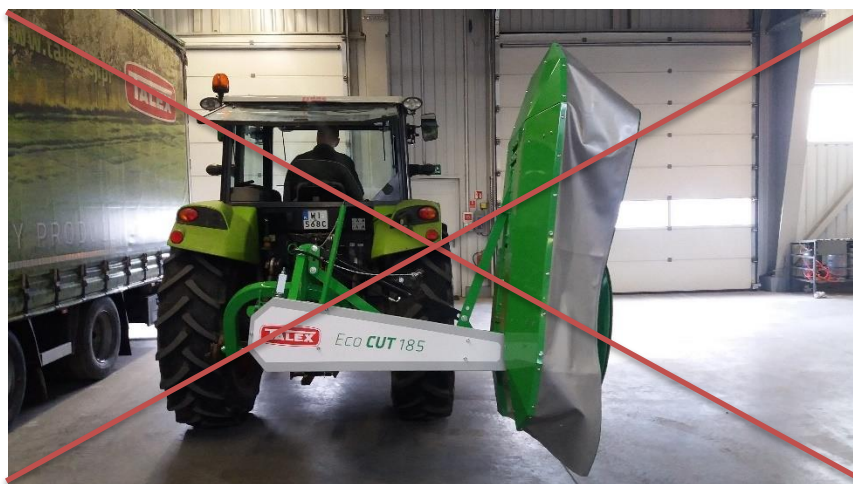
Rysunek 17 Nieprawidłowa pozycja transportowa dla kosiarek 2,10; 1,85; 1,65 oraz 1,35 w wersji z siłownikiem hydraulicznym (szerokość transportowa powyżej dopuszczalnej)
