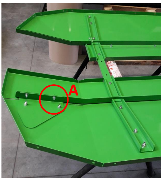
Rysunek 33 Etap V Montaż łączenia osłony prawej
