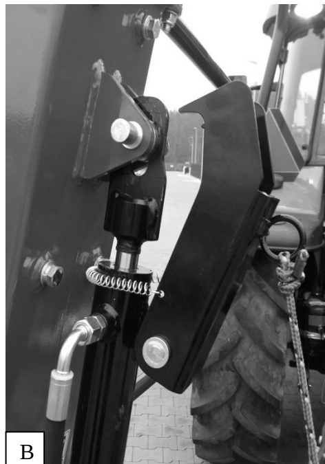
Abbildung 12 Verschluss des Zylinders: A - geschlossen, B - offen
