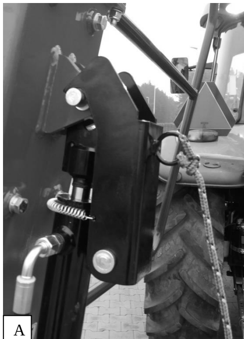
Abbildung 12 Verschluss des Zylinders: A - geschlossen, B - offen
