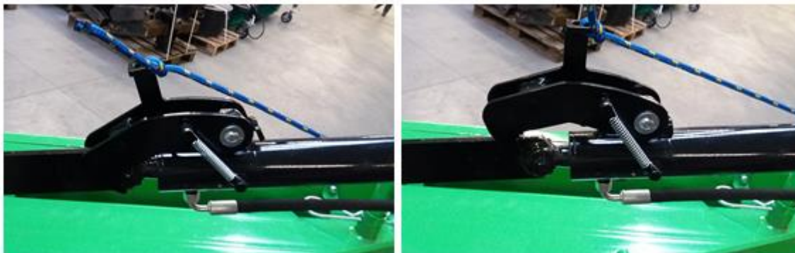
Abbildung 14 Die richtige Transportposition für die Mähwerke 2,10 m, 1,85 m, 1,65 m und 1,35 m Variante mit Hydraulikzylinder.
