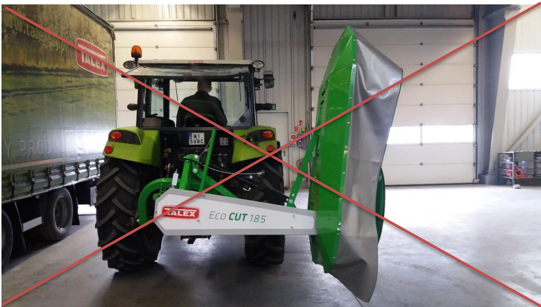
Abbildung 17 Die falsche Transportposition für die Mähwerke 2,10 m 1,85 m, 1,65 m und 1,35 m Variante mit Hydraulikzylinder (zulässige Transportbreite wurde überschritten)
