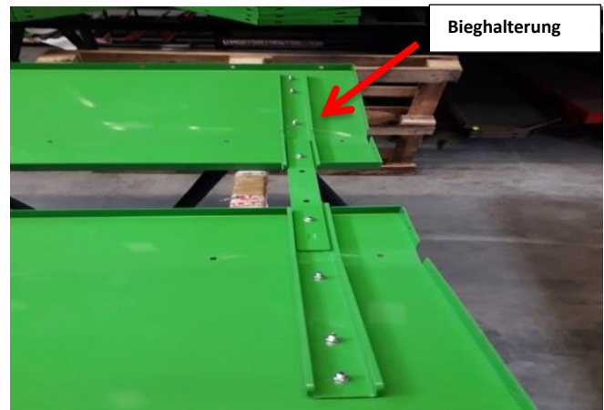
Abbildung 28 Stufe II Montage der Bieghalterung
