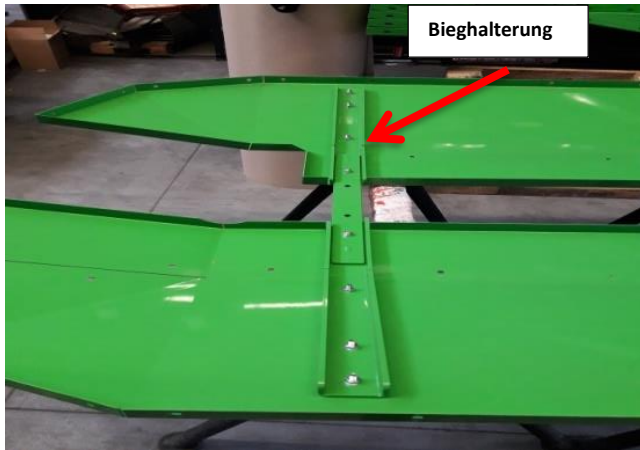
Abbildung 27 Stufe II Montage der Bieghalterung
