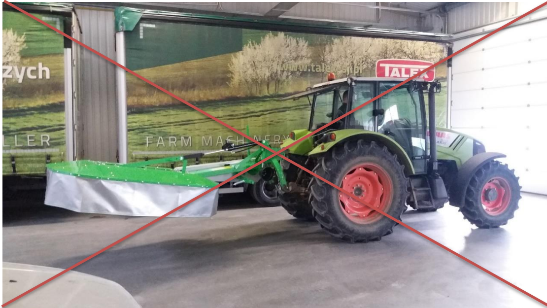
Abbildung 16 Die falsche Transportposition für die Mähwerke 2,10 m, 1,85 m, 1,65 m und 1,35 m Variante mit Hydraulikzylinder.
