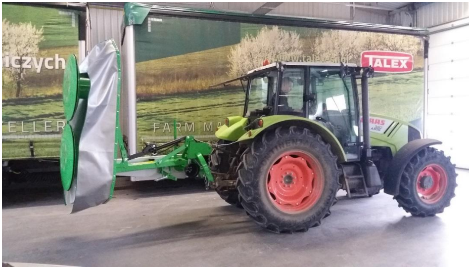
Abbildung 14 Die richtige Transportposition für die Mähwerke 2,10 m, 1,85 m, 1,65 m und 1,35 m Variante mit Hydraulikzylinder.
