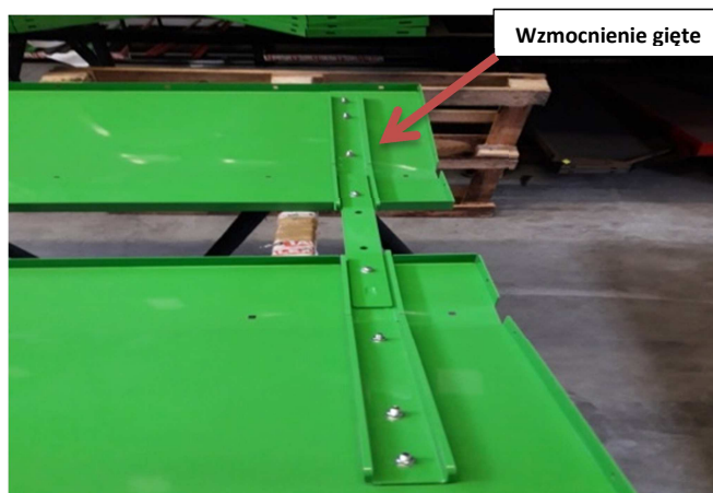
Rysunek 13 Etap II montaż wzmocnienie giętego
