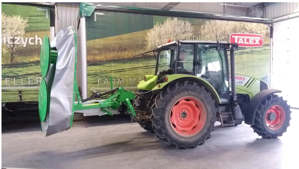
Rysunek 14 Właściwa pozycja transportowa dla kosiarek 2,10m; 1,85m; 1,65m oraz 1,35m w wersji z siłownikiem hydraulicznym
