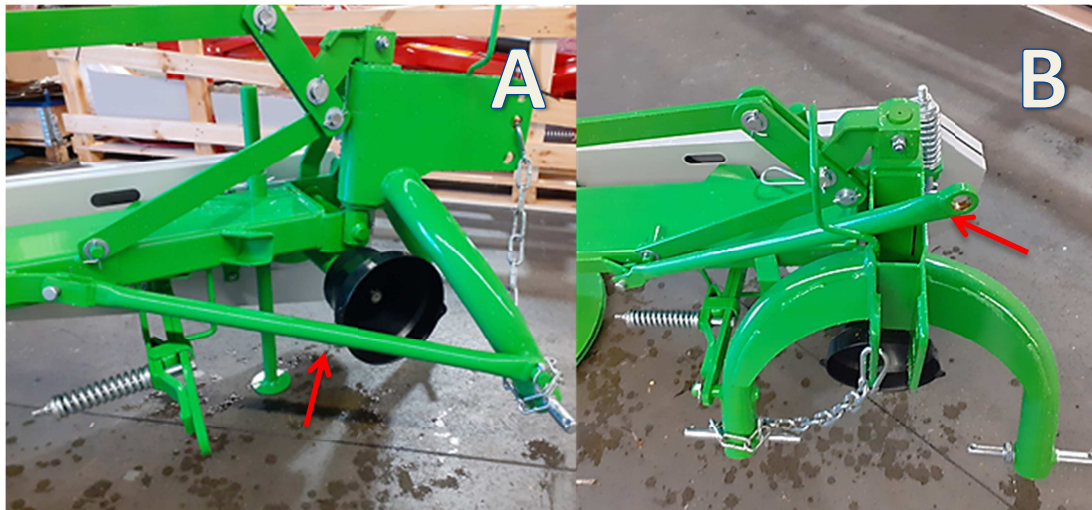
Rysunek 10 Pozycja transportowa oraz robocza dla kosiarki 1,35m
