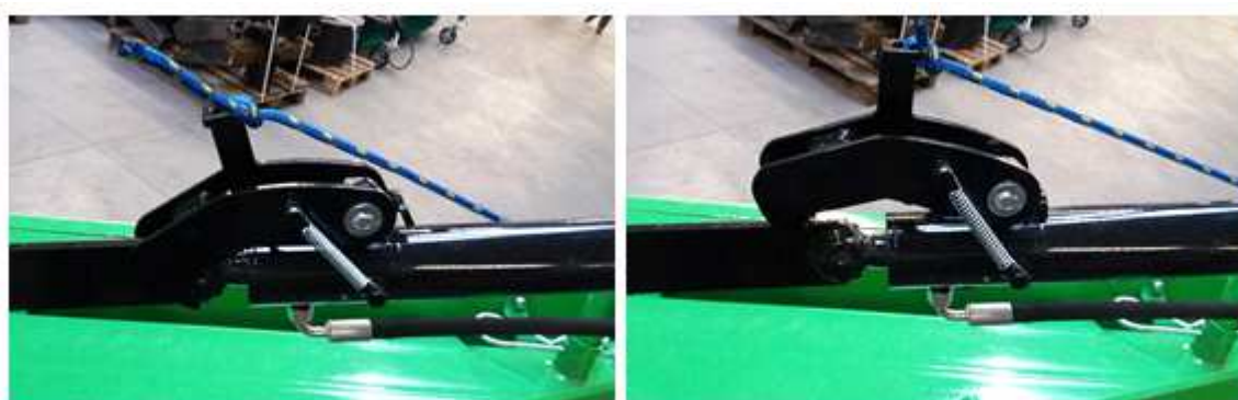
Rysunek 14 Właściwa pozycja transportowa dla kosiarek 2,10m; 1,85m; 1,65m oraz 1,35m w wersji z siłownikiem hydraulicznym
