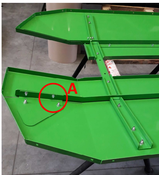
Rysunek 18 Etap V Montaż łączenia osłony prawej
