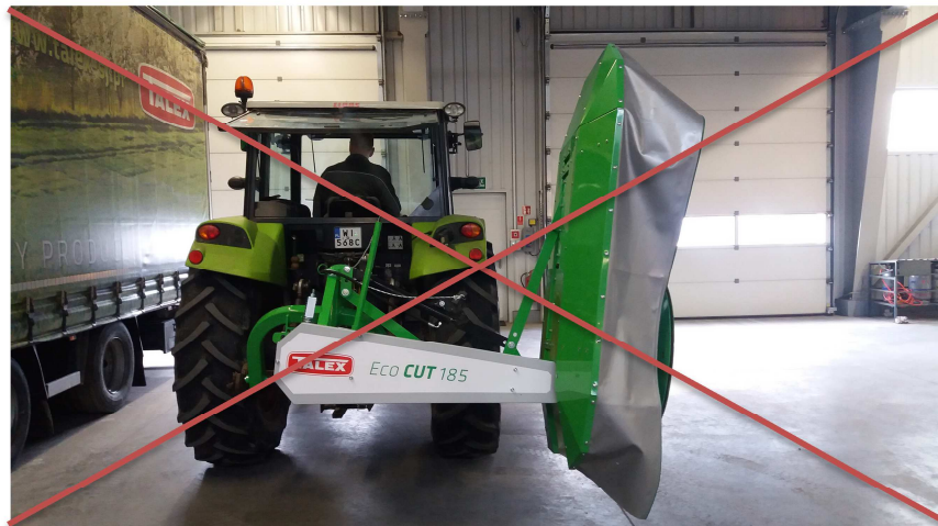
Rysunek 17 Nieprawidłowa pozycja transportowa dla kosiarek 2,10; 1,85; 1,65 oraz 1,35 w wersji z siłownikiem hydraulicznym (szerokość transportowa powyżej dopuszczalnej)
