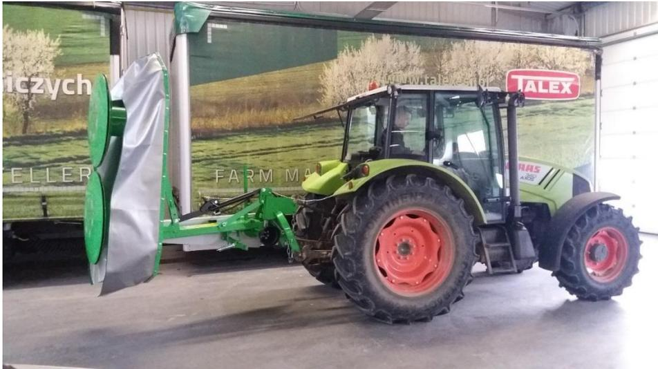
Abbildung 14 Die richtige Transportposition für die Mähwerke 2,10 m, 1,85 m, 1,65 m und 1,35 m Variante mit Hydraulikzylinder.
