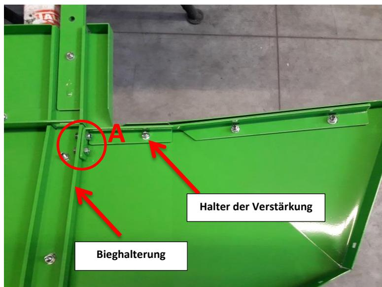
Abbildung 30 Stufe IV Montage vom Halter der Verstärkung
