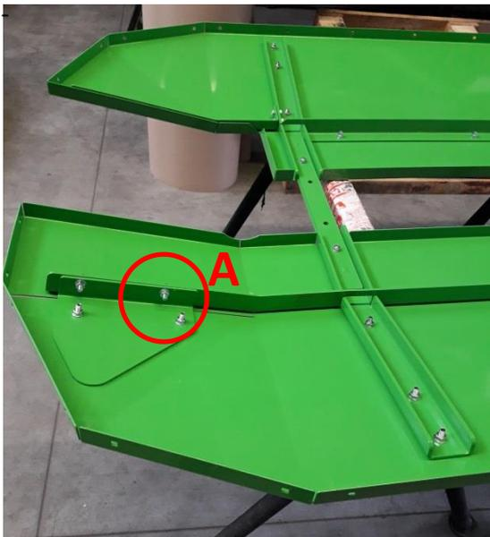
Abbildung 9 Stufe V Montage der rechten Schutzabdeckung
