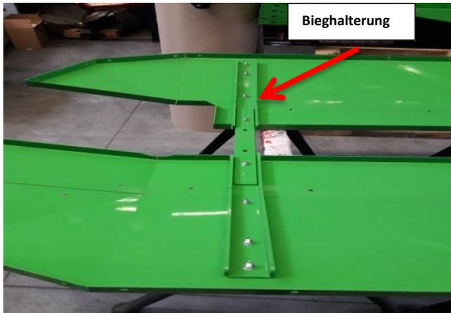
Abbildung 5 Stufe II Montage der Bieghalterung
