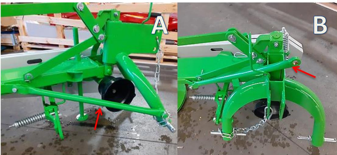
Abbildung 10 Transport- und Arbeitsposition für Mähwerk 1,35
