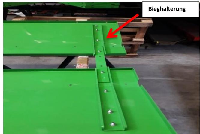
Abbildung 6 Stufe II Montage der Bieghalterung
