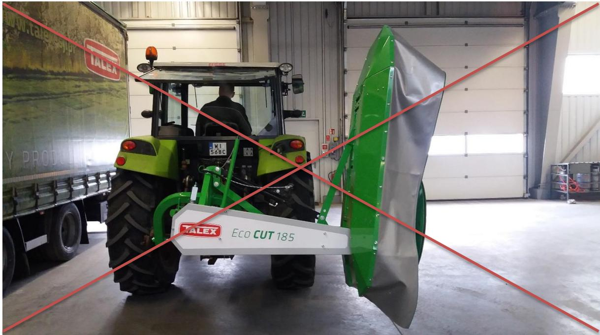
**Abbildung 17 Die falsche Transportposition für die Mähwerke 2,10 m 1,85 m, 1,65 m und 1,35 m Variante mit Hydraulikzylinder (zulässige Transportbreite wurde überschritten)**
